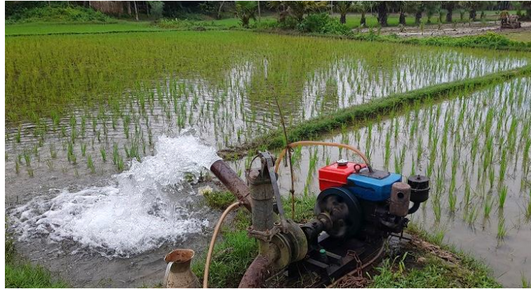
চিত্র ২. সরাসরি বা অ-প্রত্যাবর্তন ওয়াটার কুলিং ব্যবস্থা
